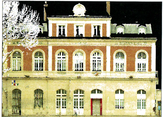
Figure 314. Orthophoto de la façade, exportée au format tif. Résolution 1 pixel/cm © Leica Cyclone)
