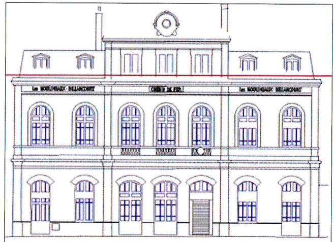
Figure 315. Plan de façade (importation de l'orthophoto dans Autocad, puis dessin en 2D) © DR
