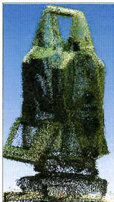
Figure 290. Nuage de points colorisé avec les codes RVB, assemblé, et nettoyé © 3D Reshaper
